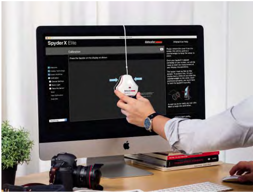
Monitorcheck: Kalibrierungsgeräte wie Spyder X Pro (ca. 180 Euro) messen die Farben von Monitoren aus und erstellen gerätespezifische Farbprofile. Diese werden ins Betriebssystem eingebunden und sorgen so für standardisierte Farben.
